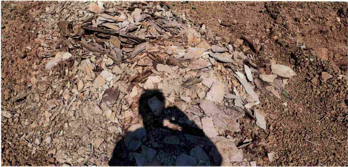
Bild 5: Aushub aus dem Posidonienschiefer in Schurf6
