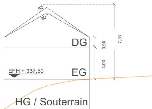
Abbildung 11: Schemaschnitt WR 5 bzw. WR 6
