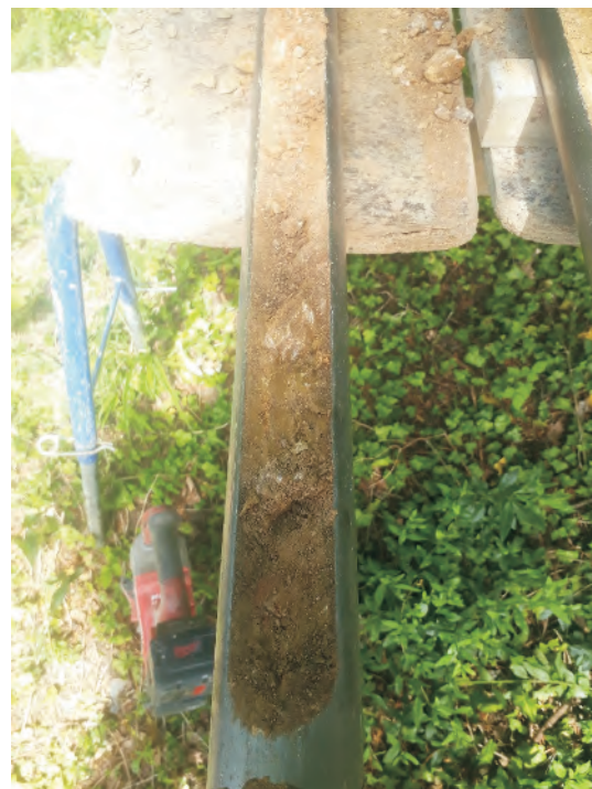
Abb. 4: rasche Zunahme des Tongehaltes mit zunehmender Tiefe, RKS 3
