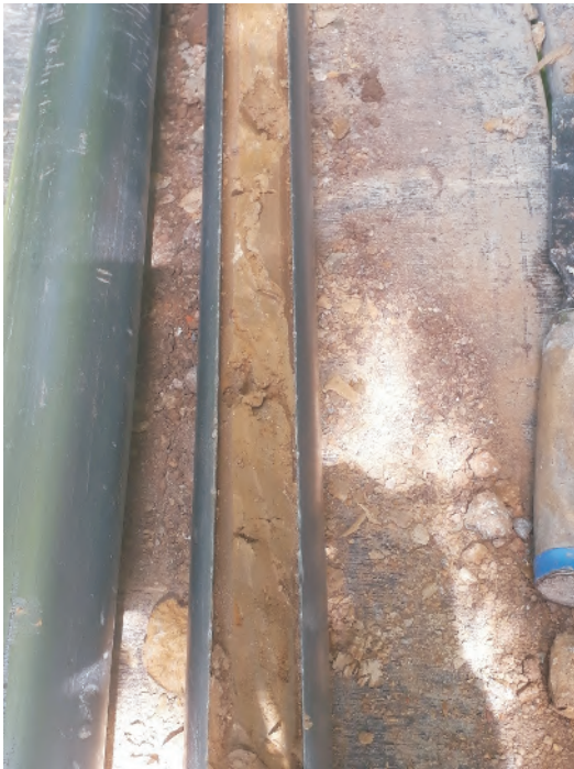
Abb. 5: sehr toniges Substrat mit geringer Durchlässigkeit, RKS 2
